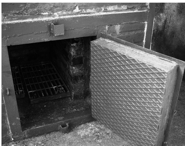
Figure 1. Le portillon central ouvre sur la chambre de combustion, dans laquelle la grille est visible.
